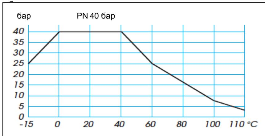
Рис. 9. Зависимость рабочего давления от температуры перемещаемой среды.
