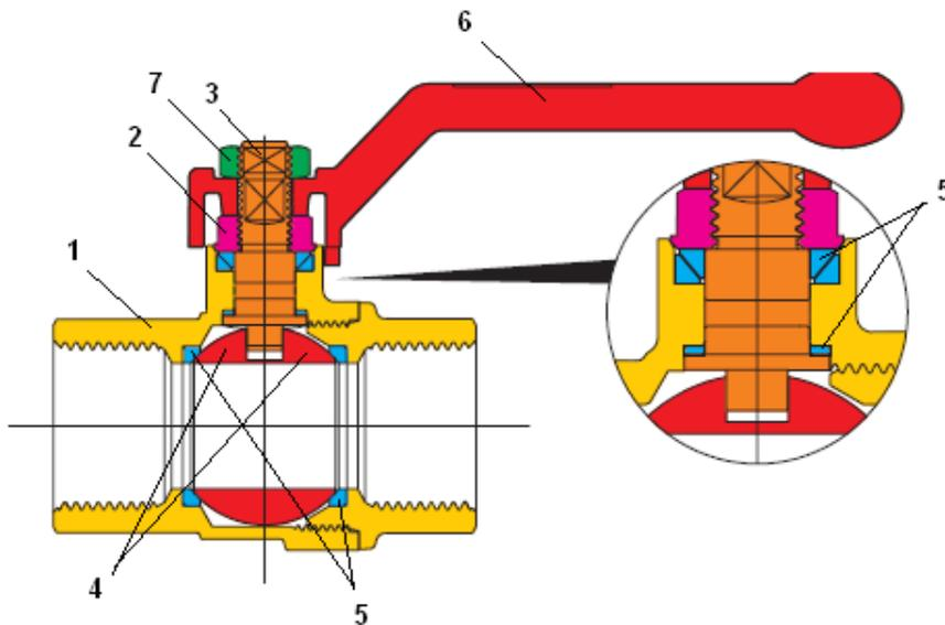
**Рис. 4.** Конструкция шарового крана DN 50 - 100 мм
