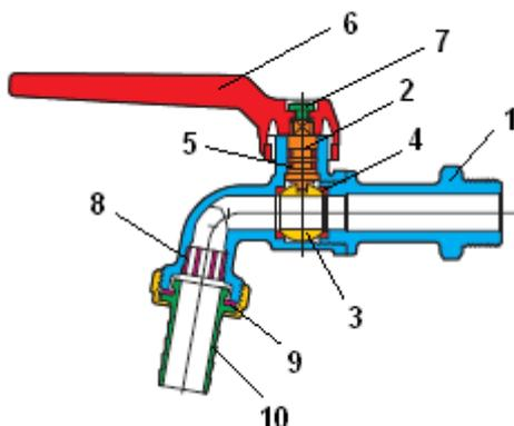
Рис. 15. Конструкция шарового крана DN 25 мм
