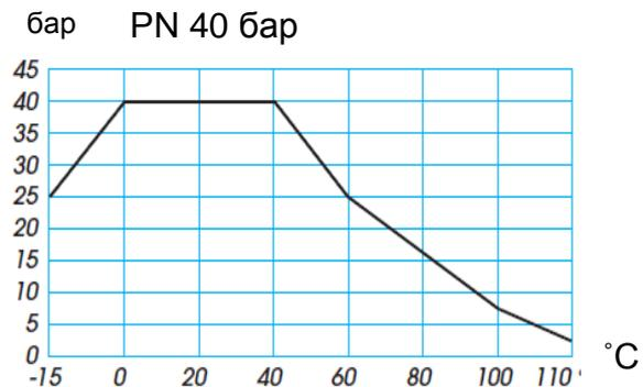
Рис. 6. Зависимость рабочего давления от температуры перемещаемой среды
