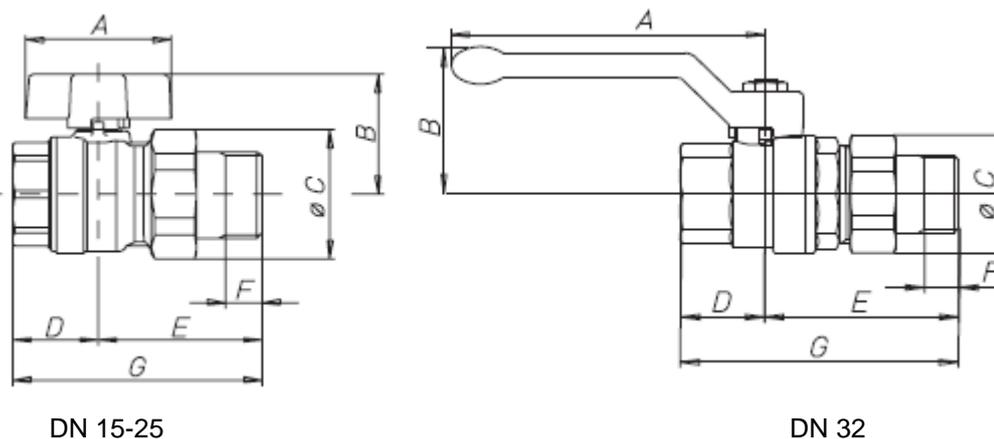
Рис. 8. Габаритные размеры
