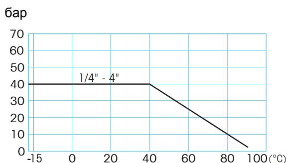
Рис. 18. Зависимость рабочего давления от температуры перемещаемой среды
