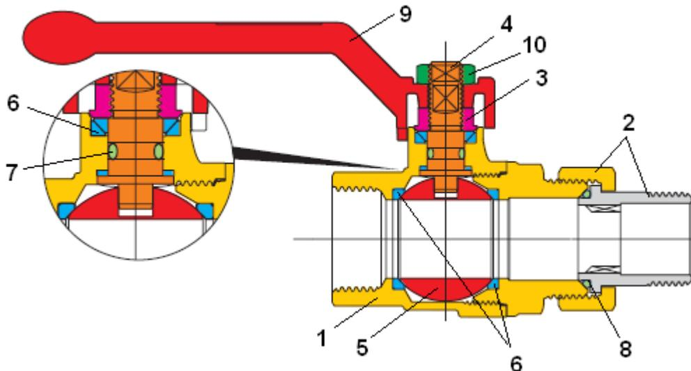
**Рис. 11.** Конструкция шарового крана DN 32 мм
