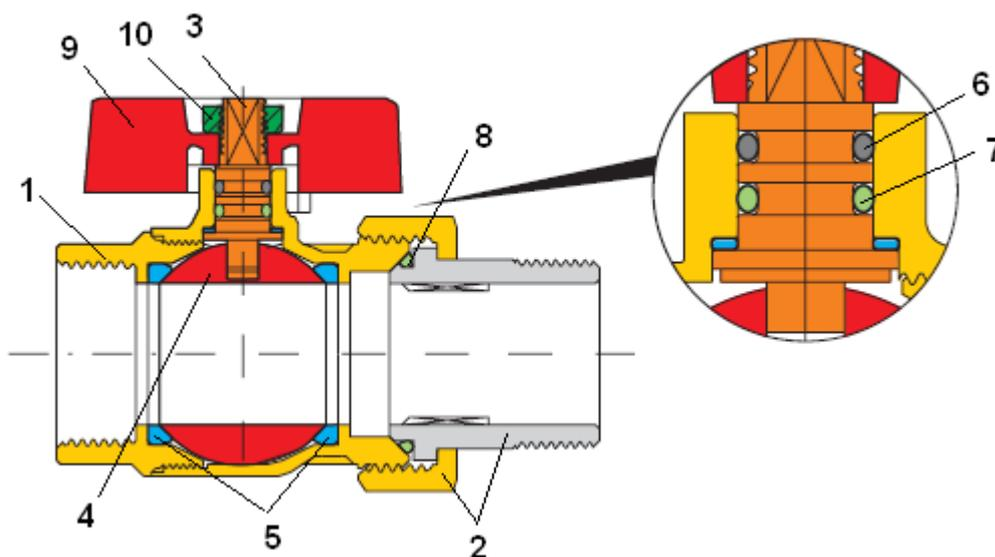
Рис. 10. Конструкция шарового крана DN 15 - 25 мм
