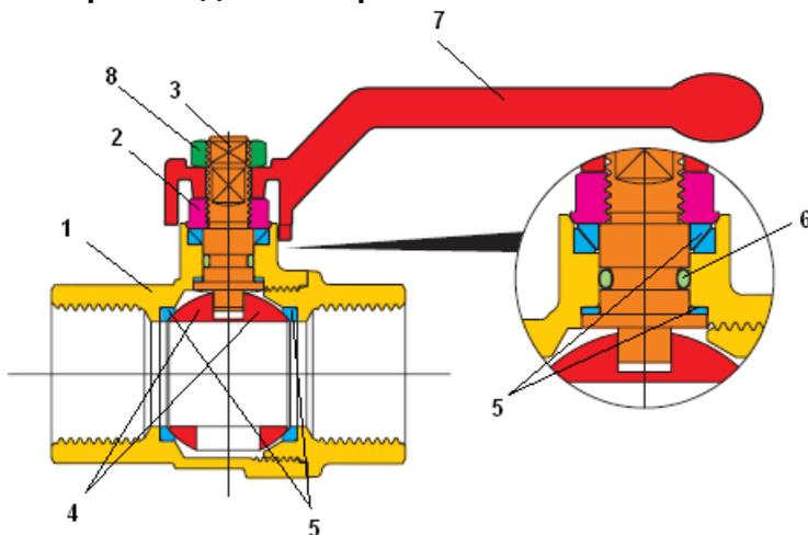
Рис. 3. Конструкция шарового крана DN 15-50 мм.
